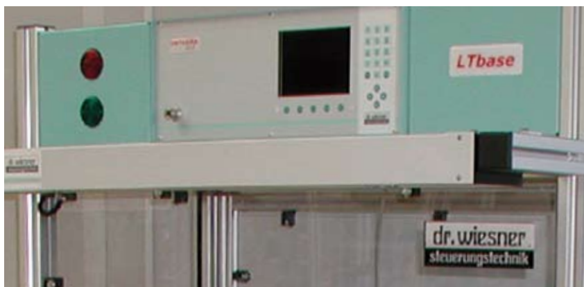
Lecktestsystem INTEGRA und optionale Arbeitsplatzbeleuchtung
