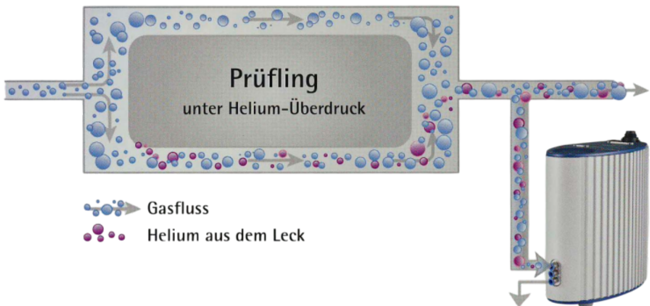
Funktionsprinzip des Helium-Akkumulationsverfahrens
