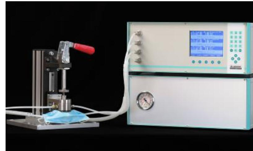
**Automatisiertes Massefluss- und Druckmessgerät
