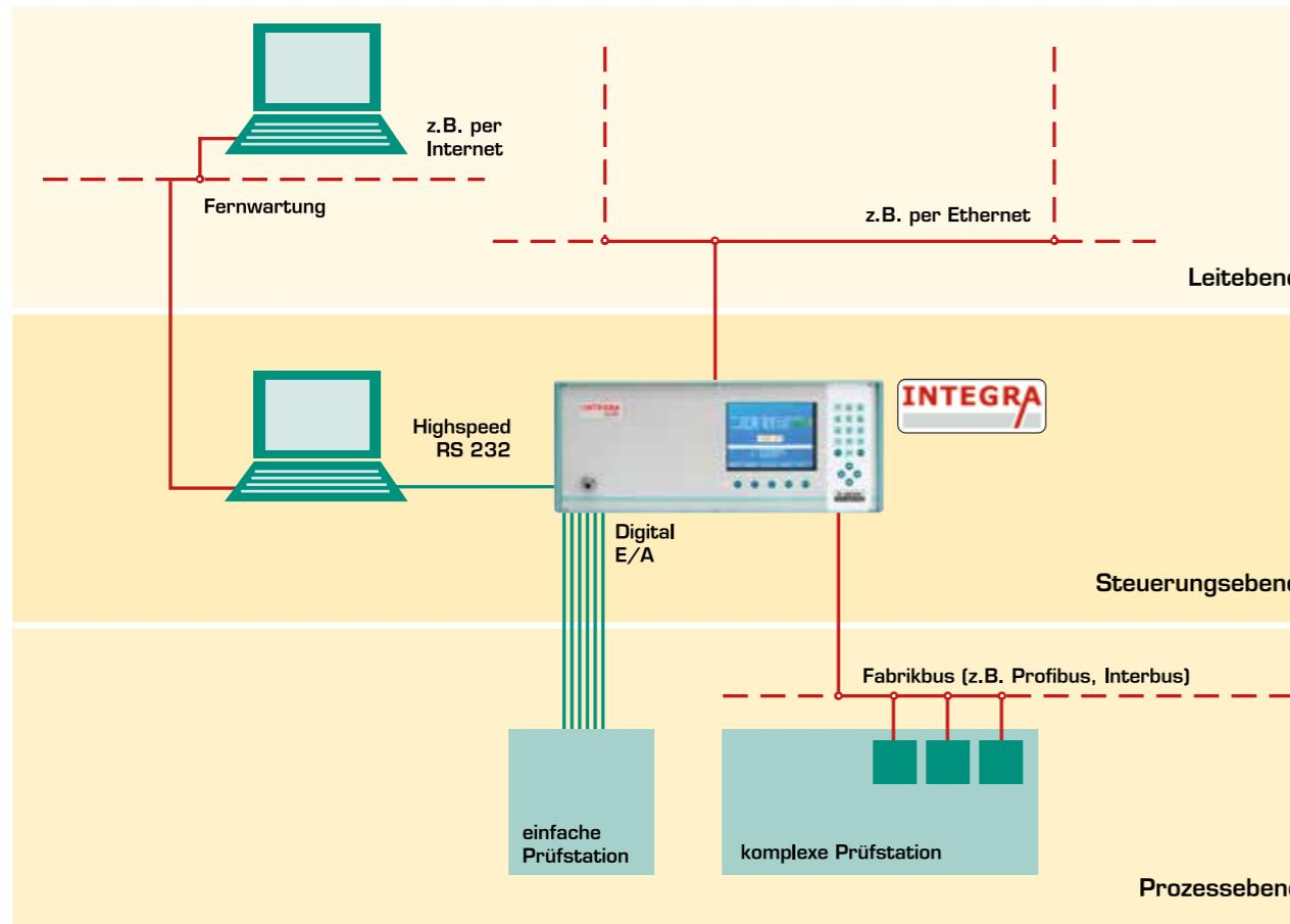
Das Lecktestsystem INTEGRA kann vollständig und zukunftssicher in die moderne Kommunikationsumgebung integriert werden.
